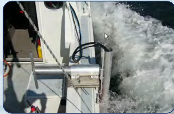
Pré-test, en face de Rimouski, du comportement du bras pour le montage du Sonic 2022.
